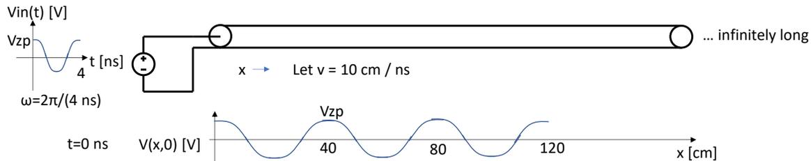
$$V_{in}(t) = V_{zp} \cos(\omega t)$$
