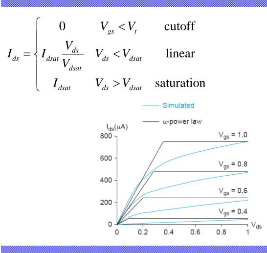
$I_{dsat} = P_c \frac{\beta}{2} \left( V_{gs} - V_t \right)^{\alpha}$  $V_{dsat} = P_v \left( V_{gs} - V_t \right)^{\alpha/2}$
